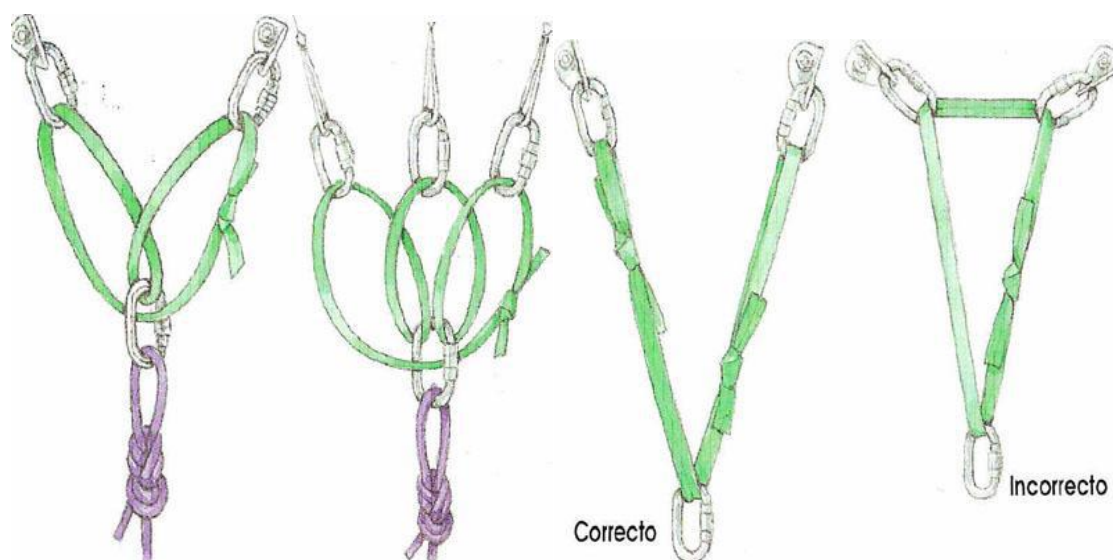
Izq: Anclaje autoigualador, repárese en los bucles del cordino. Der: Triangulo "peligroso"
